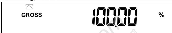
b) 此时卸下样品，放上待称物品，即显示当前物品相对于样品重量的百分比。(加载 5.00kg)如图：
